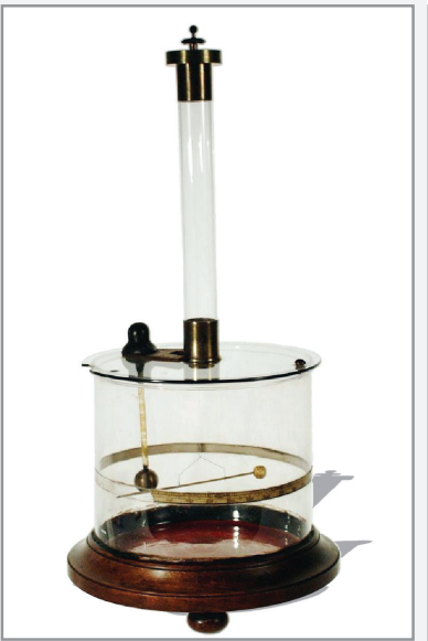
Resim 2.1: Coulomb'un burulma terazisi
