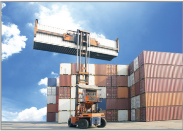
Resim 1.53: Forkliftin konteyneri kaldırması
